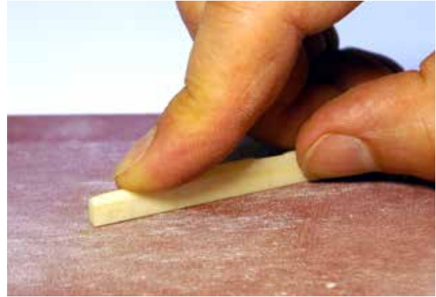
26 Anschleifen der Stegeinlage an der Unterseite auf dem Schleifpapier.
